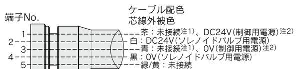
結線図 (DeviceNet®, EtherNet/IP™) 注1) DeviceNet®の場合
