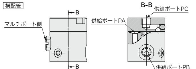
マルチポート側を左、エア供給ポートPB側を右にした時に、鋼球が見えない場合、エア供給ポートPAはプラグされています。
