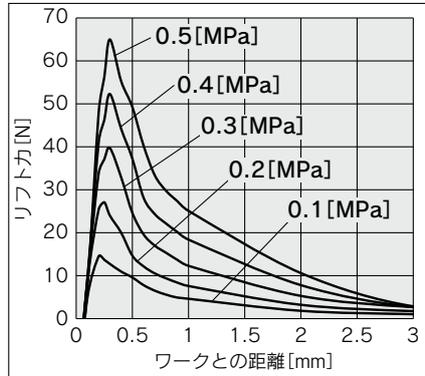
※リフト力は、ワークの形状、大きさ、表面の凹凸、通気性、柔軟性などの影響により変化しますので、上記表を目安(参考値)とし、実機にて検証確認を行ってください。
