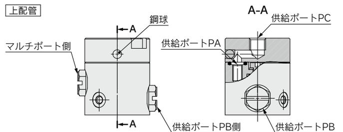
マルチポート側を左、エア供給ポートPB側を右にした時に、鋼球が見える場合、エア供給ポートPAとPCが連通しています。
