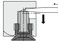
精密ドライバ等を使用し、ボディの横穴からスプリングピンを押し出し、スプリングピンとストツパを取出します。
