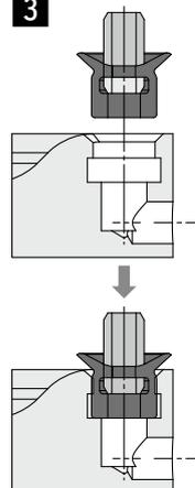
スプリングピンを挿入したストツパをボディに挿入します。<sup>注)</sup>
