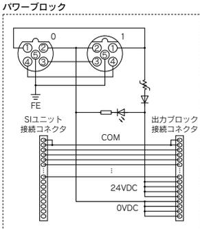
注) SIユニットに供給するハルブ電源をOFFした場合、出力ブロック (EX9-OE□) の出力は常時OFFになります。
