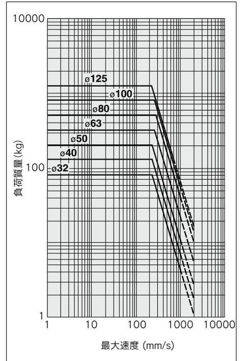
例) φ63のエアシリンダを最大速度500mm/sで動かすときのロッド先端負荷制限を求める。グラフの横軸500mm/sより上に延長しチューブ内径63mmのラインとの交点を左に延長し負荷80kgが求められます。
