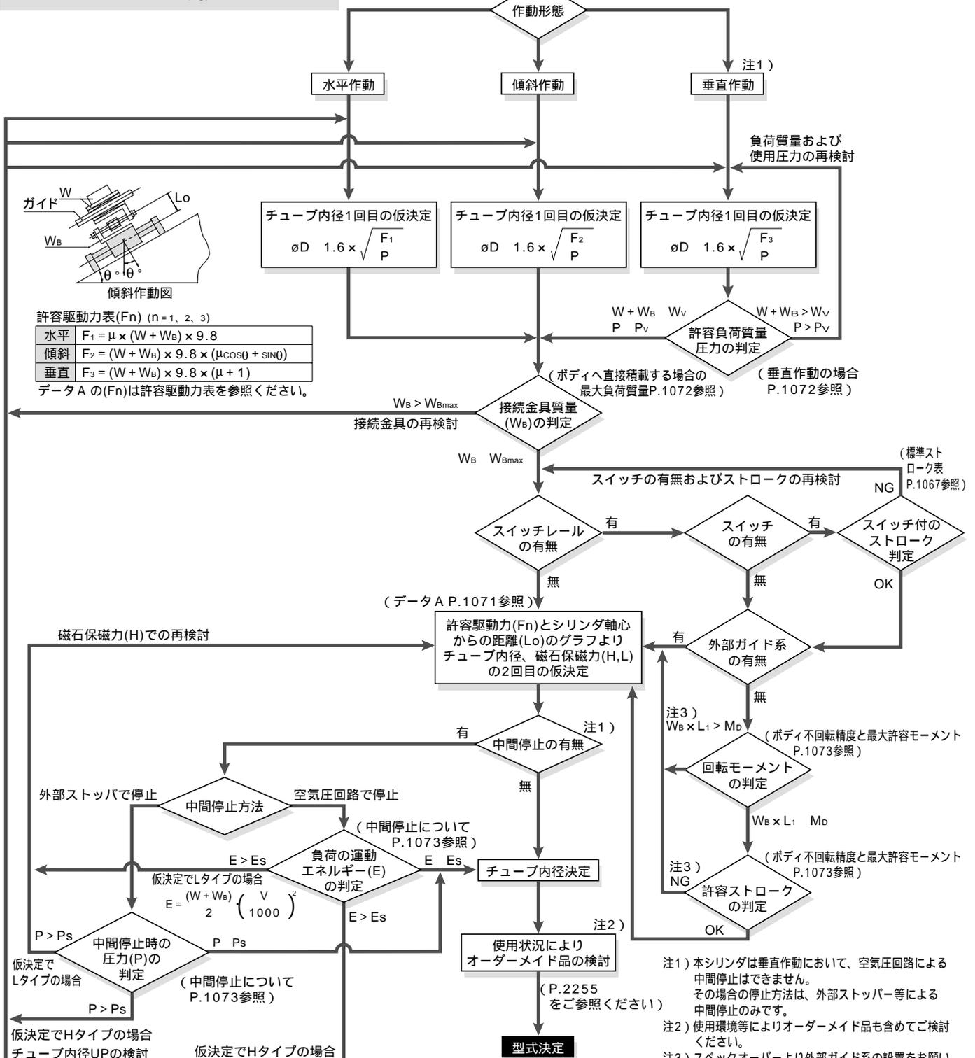
注1) 本シリンダは垂直作動において、空気圧回路による中間停止はできません。その場合の停止方法は、外部ストッパー等による中間停止のみです。
