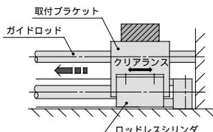
取付ブラケットとシリンダにクリアランスを設け、軸心のズレ量を吸収させます。なお、取付ブラケットをシリンダの軸心以上のばし、シリンダにモーメントを受けないようにします。
