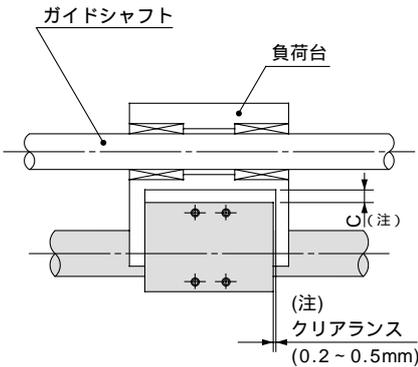
(注) 下図の自重たわみを参考に、シリンダが取付面および負荷等と接触しないようフルストローク最低作動圧力範囲内でスムーズに作動できるように、クリアランスを設定してください。
