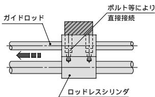
負荷とシリンダの軸心の心ずれ吸収ができず作動不良の原因となります。
