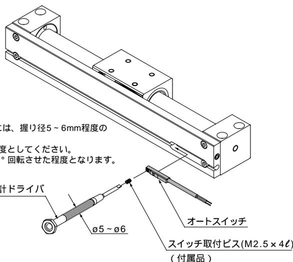
注) オートスイッチ取付ビスを締める際には、握り径5~6mm程度の時計ドライバを使用してください。
