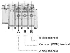
Figure 13. Plug-in contact terminal (VFR2000/3000/4000)
